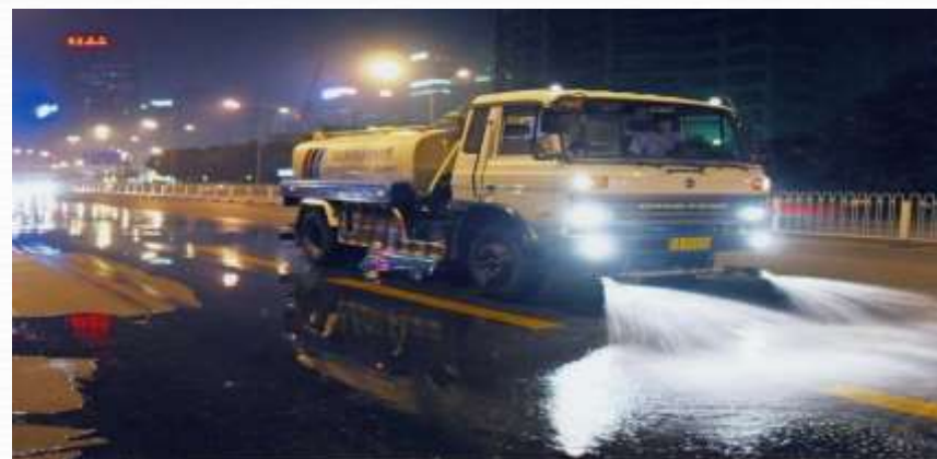
Used for municipal sprinkling 市政道路清扫使用再生水
